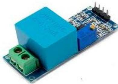
Fig. 3 Voltage Sensor
