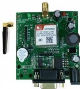
Fig. 9. GSM modem.
