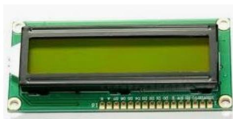
Fig. 5. 16\*2 LCD Module
