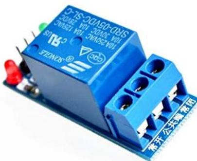
Fig. 8. Relay Module
