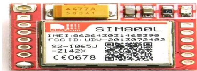
Fig. 7. SIM800L GSM/GPRS modem
