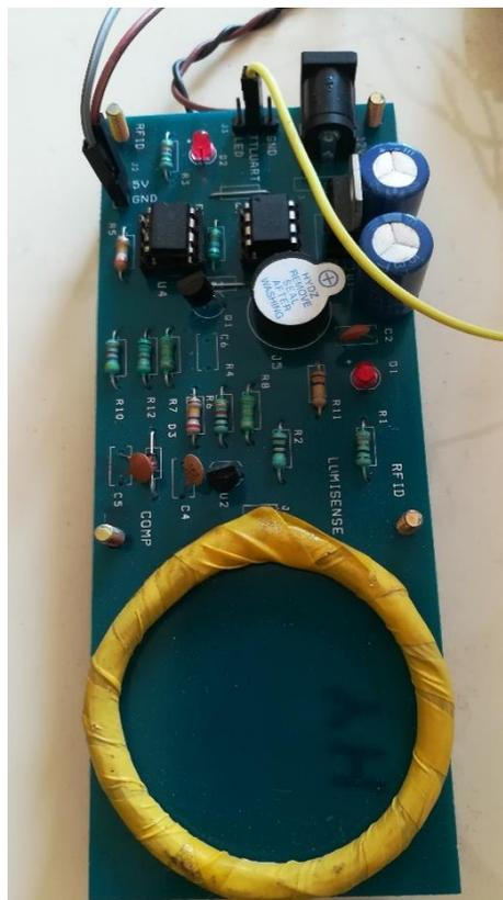
**Fig. 3.** RFIDSensor
